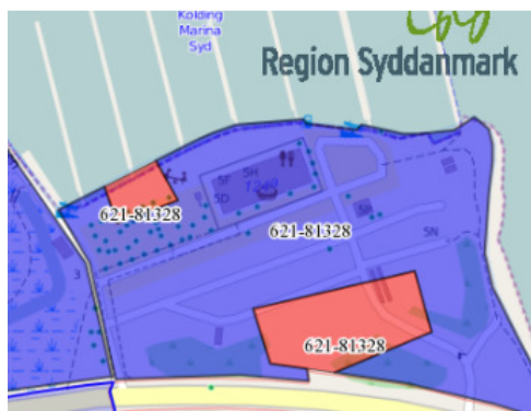
Figur 09.1 Forurenede arealer. Blå er V1-kortlagt, rød er V2-kortlagt og lyserød er områdeklassificeret (Kilde: Region Syddanmarks hjemmeside på https://regionsyddanmark.dk/wm282374 ).
